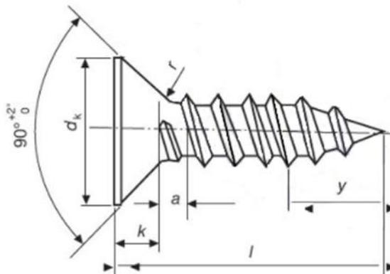
Figura 1 - Parafuso para Madeira Cabeça Chata – Tipo 1
